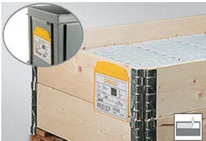
verwenden. Ist der größere Teil der Box geleert, wird sie umgedreht, um eine Reservemenge zugänglich zu machen. Durch die Drehung des Behälters wird ein RFID-Chip in die Nähe eines Lesegerätes bewegt und automatisch eine Nachbestellung ausgelöst. Echte Kanban-Karten werden bei einem solchen Verfahren gar nicht mehr benötigt.
